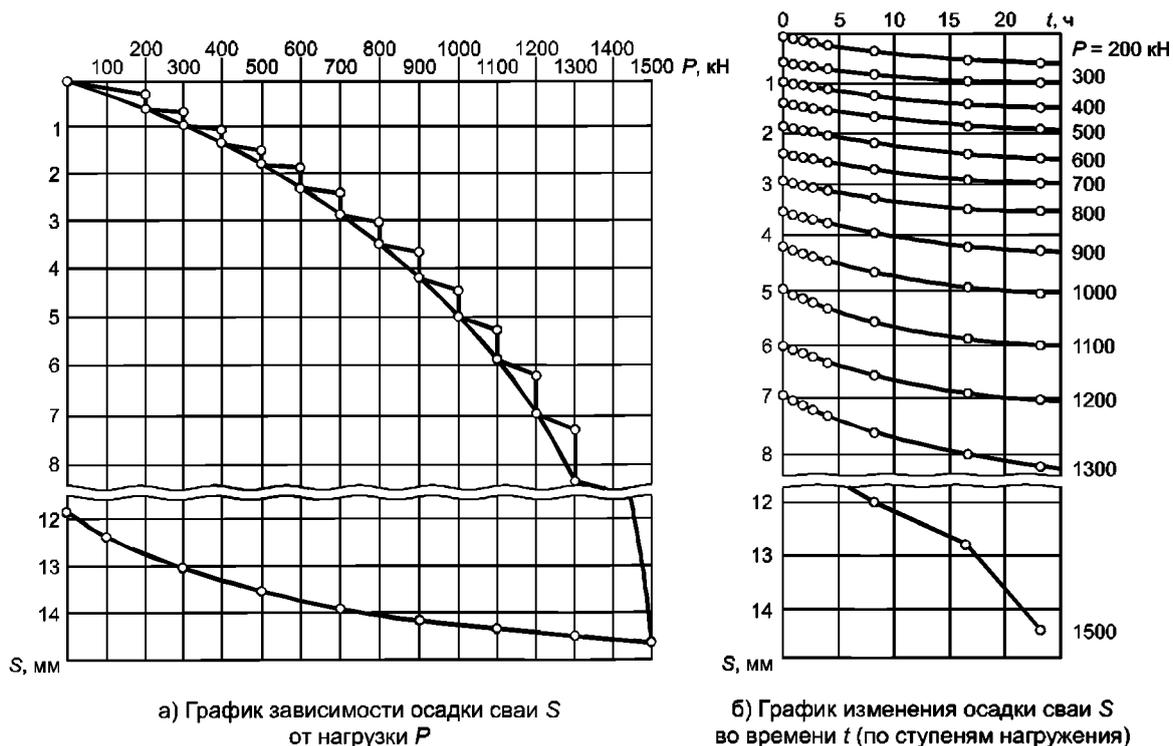
а) График зависимости осадки сваи  $S$
