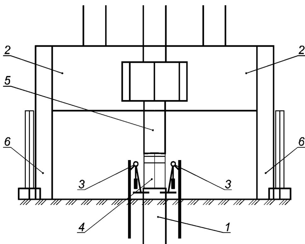
и) Схема установки для испытания грунтов сваями с использованием сваевдавливача
